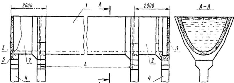
1—испытуемый лоток; 2—укороченный лоток (2 шт.); 3—заглушки; 4—опоры лотков; 5—прокладка.
